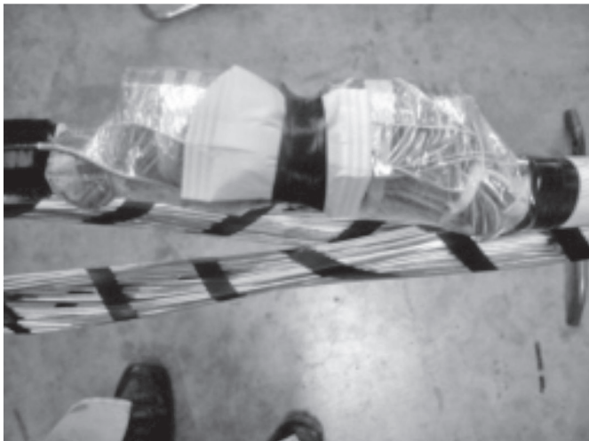
7) Připevněte sáček silicagelu zbaveného aluminiového obalu.
